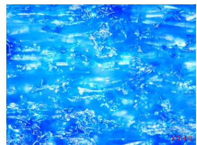
Fig4. Cross section of filter layer 【model:MMF-0086】
